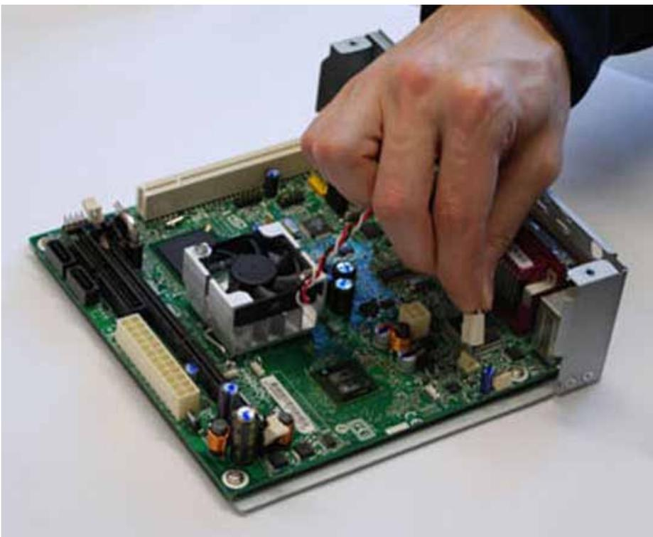
Nun die nächste Klammer des 2. Lüfters **sehr vorsichtig** in Richtung des 1. entfernten Kühlkörpers und gleichzeitig nach unten drücken.
