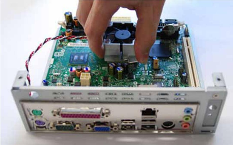
Reinigen Sie nun die CPU (markiert) und den Chipsatz (markiert).
