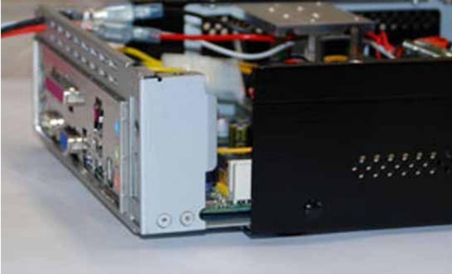
Nun schließen Sie die Festplatte mit dem Adapter SATA-HDD 2,5" zu SATA-MB und Strom an, dieses lässt sich ebenfalls nur in einer Position anschließen.
