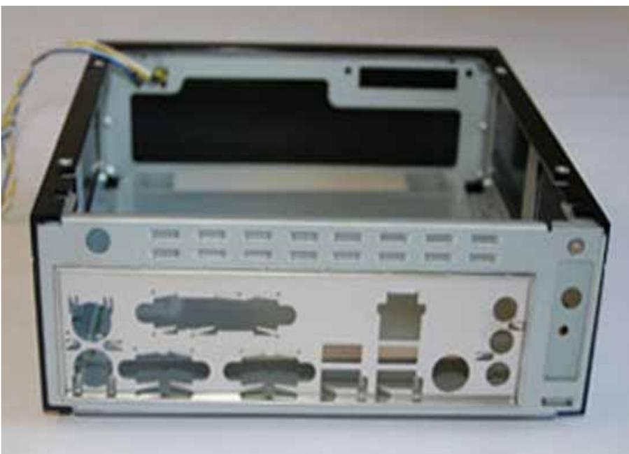
Als nächstes schieben Sie das Gehäuse und die Isolationsplatte auseinander - wie eine Schublade.
